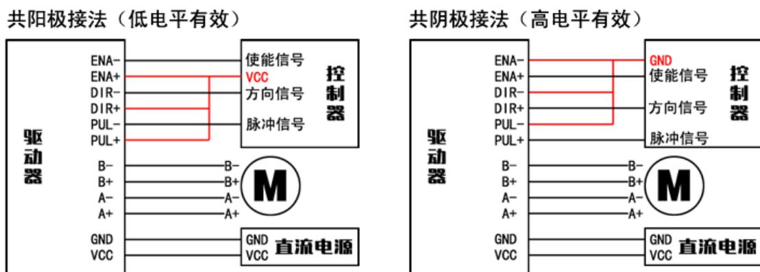
**注意1:** 图中控制器与驱动器的VCC和GND尽量不要共用一个电源，防止任何一个损坏造成另一个的损坏，除非控制器内部有电源隔离。
